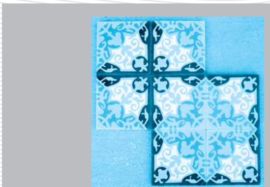
شکل ۲ نمونه‌ای از کاشی و سرامیک. مواد اولیه تولید سرامیک و بدنه کاشی یکی است. برای ایجاد تخلخل و کاهش دمای ذوب، کمک ذوب‌هایی مانند آهک و آهن اکسید به مخلوط این مواد (خاک رس، کوارتز و فلدسپات) می‌افزایند.
